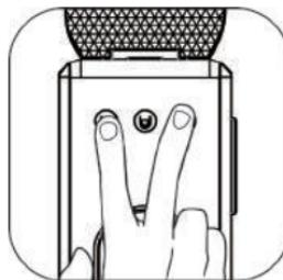
В режиме ожидания нажмите и удерживайте кнопки Espresso и Lungo в течение 3 секунд, раздастся звуковой сигнал, и кофемашина перейдет в режим энергосбережения /режима отключения.
