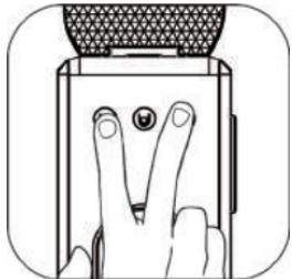
В режиме энергосбережения одновременно нажмите и удерживайте кнопки Espresso и Lungo в течение 3 секунд, после звукового сигнала кофемашина перейдет в режим настройки температуры. Нажмите кнопку Espresso один раз, и температура снизится на 2 градуса по Цельсию, нажмите дважды для снижения температуры на 4 градуса и так далее.
