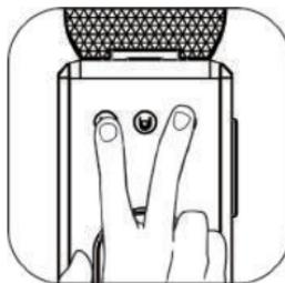
开机状态下，长按大杯和小杯按键3秒，蜂鸣器长“嘀”一声后，机器进入省电/关机模式。
