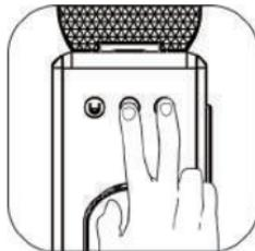
再次长按大杯和中杯按键3秒，蜂鸣器长“嘀”一声表示已保存刚才设置的杯量。
