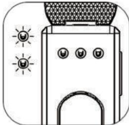
蜂鸣器长“嘀”一声后小杯和中杯指示灯以2次/秒的频率轮流闪烁，表示清空完成，此时只能按关机或者拔出电源线才能清除这个状态。
