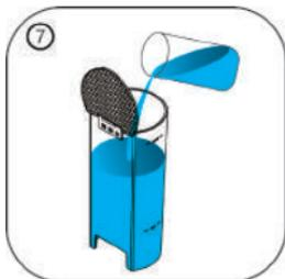
Reabasteça o depósito de água com o agente de descalcificação e encha com água até à linha MAX. Em seguida, proceda novamente à descalcificação até que o depósito de água fique vazio.
