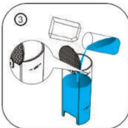
Añada el descalcificador de acuerdo con las instrucciones y mézclelo con agua, llénelo en el depósito de agua hasta la línea MAX. (unos 700 ml).
