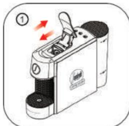
Heben Sie den Hebel an und schließen Sie ihn, um die Kapsel in den Behälter für gebrauchte Kapseln auszuwerfen.
