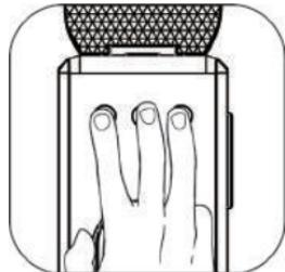
Im Energiesparmodus halten Sie die drei Tasten gleichzeitig 3 Sekunden lang gedrückt. Nachdem der Summer ertönt und die drei Tasten 5 Mal blinken, schaltet das Gerät in den Wassermodus bei Raumtemperatur um und der Heizkessel hört auf zu heizen.
