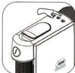
Im Energiesparmodus halten Sie die Espressotaste 3 Sekunden lang gedrückt, die Maschine wechselt in die Funktion zur Auswahl der Wasserqualität, drücken Sie die Espressotaste einmal, um die Wasserqualität um eine Stufe zu verringern, drücken Sie sie zweimal, um eine weitere Stufe zu verringern, usw.
