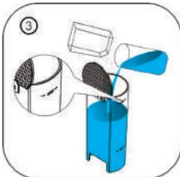
Coloque o agente de descalcificação de acordo com as instruções e misture com água, encha o depósito de água até à linha MAX.
