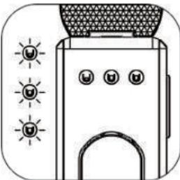
После непрерывной работы с использованием 1,5 л воды, сработает предупреждение о длительной работе для защиты кофемашины. Три кнопки мигают поочередно, а звуковой сигнал работает непрерывно. (Пауза более 2 минут во время приготовления не считается непрерывной работой).
