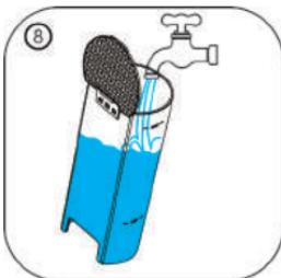
Spülen Sie den Wassertank und mit frischem Trinkwasser füllen.
