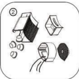
Vacie la bandeja de goteo, la base de goteo y el contenedor de cápsulas usadas.
