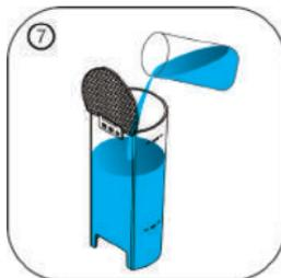
Füllen Sie den Wassertank mit dem Entkalkungsmittel und Wasser bis zur MAX.-Linie, dann erneut entkalken, bis der Wassertank leer ist.
