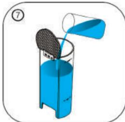
再次向水箱倒入配比好的除垢剂至最高水位线(700ml左右)并再次除垢，直到清空水箱。
