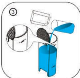
Geben Sie das Entkalkungsmittel in gemäß der Anleitung mit Wasser mischen und in den Wassertank bis zur MAX-Linie (ca. 700ml) einfüllen.
