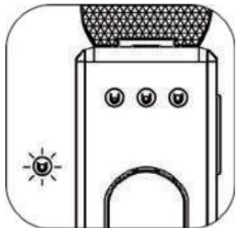
当机器连续工作温度过高，锅炉表面温度达到约140°C时，锅炉停止加热，大杯按键指示灯闪烁，机器不能正常工作。此时须拔掉电源插头重新通电，后退出过热报警。
