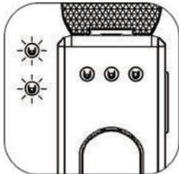
小杯和中杯按键指示灯同时以2次/秒的频率闪烁，大杯指示灯灭，发热体和水泵同时工作，直到把水箱中的水抽完，水箱中无水后，水泵停止工作，锅炉继续加热直到将锅炉中水分蒸发掉，蒸发完后，锅炉水泵停止工作。
