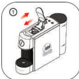
Поднимите и закройте крышку, чтобы вытолкнуть капсулу в контейнер.
