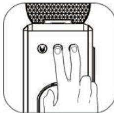
В режиме ожидания нажмите и удерживайте кнопки Lungo и Medium в течение 3 секунд, после звукового сигнала прибор перейдет в режим настройки объема, и три кнопки будут мигать одновременно.
