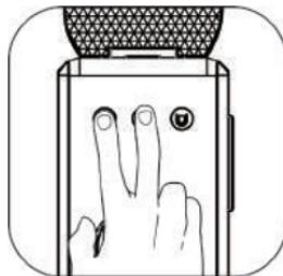
En el modo de ahorro de energía, pulse el botón Espresso y Medium para vaciar la máquina.
