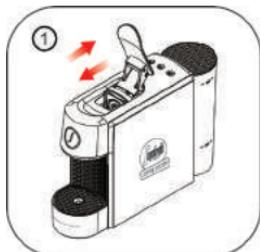
Sollevarе e abbassare la leva per espellere la capsula nel contenitore delle capsule usate.
