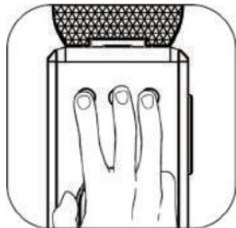
В режиме энергосбережения нажмите и удерживайте три кнопки одновременно в течение 3 секунд, после звукового сигнала три кнопки мигнут 5 раз, и прибор перейдет в режим воды комнатной температуры, бойлер прекратит нагрев.
