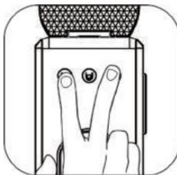
En modo de espera, mantenga pulsados los botones Espresso y Lungo durante 3 segundos, el zumbador sonará y la máquina entrará en modo de ahorro de energía /modo apagado
