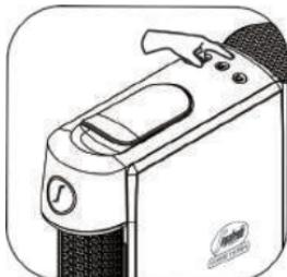
In modalità di risparmio energetico, tenere premuto il pulsante Espresso per 3 secondi; la macchina entra nella funzione di selezione del controllo della qualità dell'acqua. Premere il pulsante Espresso una volta per ridurre di un livello il controllo del livello di qualità dell'acqua, premere due volte per ridurre un altro livello e così via.
