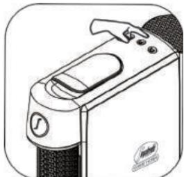
В режиме энергосбережения нажмите и удерживайте кнопку Espresso в течение 3 секунд – кофемашина перейдет в режим выбора качества воды. Нажмите кнопку Espresso один раз – показатель качества воды снизится на один уровень, нажмите дважды для снижения еще на один уровень и так далее. Нажмите кнопку Lungo для повышения уровня (всего 5 уровней).
