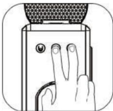
En mode veille, appuyez et maintenez les boutons Lungo et Medium enfoncés pendant 3 secondes, l'appareil passe au mode réglage de la quantité ; après le retentissement de l'avertisseur sonore, trois boutons clignotent simultanément.
