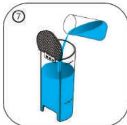
Riempire il serbatoio dell'acqua con il decalcificante e l'acqua fino alla linea MAX, poi decalcificare di nuovo fino a quando il serbatoio dell'acqua è vuoto.
