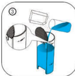
Introduisez l'agent de détartrage conformément aux instructions et mélangez avec de l'eau, remplissez le réservoir d'eau jusqu'à la ligne MAX.
