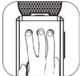
No modo de economia de energia, pressione e mantenha pressionados três botões simultaneamente por 3 segundos. Após o sinal sonoro e depois de os três botões piscarem 5 vezes, a máquina será definida no modo de água à temperatura ambiente. A caldeira deixa de aquecer.
