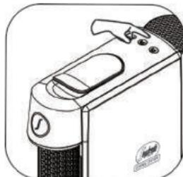
En mode économie d'énergie, maintenez le bouton Espresso enfoncé pendant 3 secondes, l'appareil passera à la fonction de sélection de la qualité de l'eau ; appuyez sur le bouton Espresso de manière à réduire d'un niveau la qualité de l'eau ; appuyez deux fois pour réduire d'un niveau de plus et ainsi de suite.
