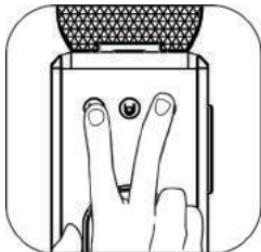
En mode économie d'énergie, appuyez simultanément sur les boutons Espresso et Lungo pendant 3 secondes, après le retentissement de l'avertisseur sonore, l'appareil passe au mode de réglage de la température; appuyez une fois sur le bouton Espresso et la température diminuera de 2 degrés centigrades, appuyez deux fois pour diminuer de 4 degrés centigrades et ainsi de suite. On peut diminuer d'un maximum de 8 degrés centigrades.
