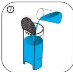
Снова заполните емкость для воды раствором со средством для удаления накипи до отметки **MAX**, и повторите полный цикл очистки.
