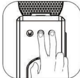
待机模式下长按大杯和中杯按键3秒，蜂鸣器“嘀”一声，三灯同时以2次/秒的频率闪烁，咖啡机进入流量设置模式。
