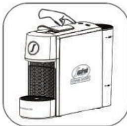
省电模式下长按中杯按键3秒，蜂鸣器“嘀”一声，机器进入预浸泡设置模式，此时指示灯按上次设置的预浸泡模式一直闪烁，此时按一下小杯按键，小杯指示灯以1次/秒的频率闪烁3次后熄灭，返回到省电模式，下次使用机器无预浸泡功能（机器默认模式）。
