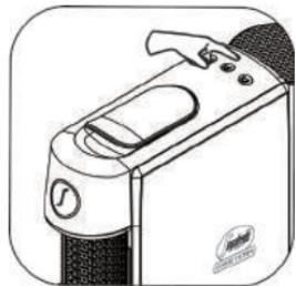
省电模式下，长按小杯按键 3秒，机器进入水质选择模式，此时若按动小杯按键一次，则水质硬度等级降低一个级别，再按动一次则再降低一个级别，以此类推直至机器降为低硬度水质等级。若按动大杯按键一次，则相反，机器水质硬度等级越来越高（共五个等级）。
