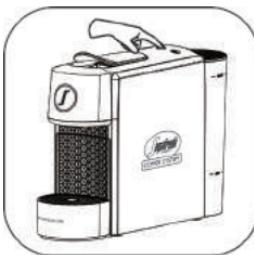
En mode d'économie d'énergie, maintenez le bouton Medium enfoncé pendant 3 secondes, l'avertisseur sonore retentit et l'appareil passe au mode de réglage de pré-percolation. Appuyez sur le bouton Medium, le bouton clignote 3 fois et l'appareil sera réglé sur Pré-percolation de 1,5 seconde.
