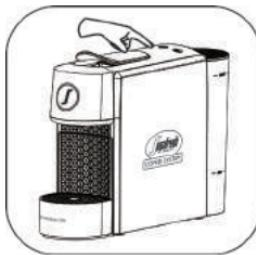
В режиме энергосбережения нажмите и удерживайте кнопку Medium в течение 3 секунд. После звукового сигнала кофемашина перейдет в режим настройки подготовки к завариванию. Нажмите кнопку Espresso, кнопка мигнет 3 раза, и кофемашина настроится на заваривание без подготовки (по умолчанию).
