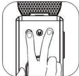
Im Energiesparmodus drücken Sie die Tasten Espresso und Lungo gleichzeitig für 3 Sekunden, nach dem Ertönen des Summers geht die Maschine in den Temperatureinstellungsmodus über, drücken Sie die Espressotaste einmal und die Temperatur sinkt um 2 Grad Celsius, drücken Sie zweimal, um 4 Grad Celsius zu senken usw. Maximal 8 Grad Celsius können gesenkt werden.
