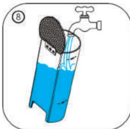
Промойте резервуар для воды и заполните свежей питьевой водой.
