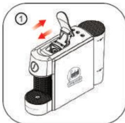
Levante y cierre la tapa para expulsar la cápsula en el contenedor de cápsulas usadas.
