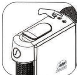
No modo de economia de energia, pressione e mantenha pressionado o botão Curto por 3 segundos. A máquina entrará na função de seleção da qualidade da água. Pressione o botão Curto uma vez para que o nível de qualidade da água reduza um nível, pressione duas vezes para reduzir mais um nível e assim por diante. Pressione o botão Cheio para aumentar o nível (total de 5 níveis).
