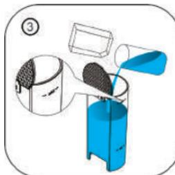
Добавьте средство для удаления накипи в воду согласно инструкции, залейте раствор в емкость до отметки **MAX**. (около 700 мл).
