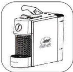
此时若按动小杯按键一次，则机器温度下降2°C，再按动一次则机器温度下降4°C，以此类推最多可下降8°C。
