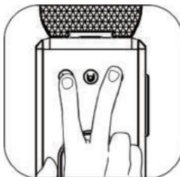
Im Standby-Modus halten Sie die Tasten Espresso und Lungo 3 Sekunden lang gedrückt, der Summer ertönt und das Gerät schaltet in den Energiesparmodus. /Schalter off Modus.
