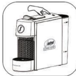
En el modo de ahorro de energía, mantenga pulsados los botones Medium y Lungo simultáneamente durante 3 segundos, después de que suene el zumbido la máquina entrará en el modo de ajuste de ahorro de energía. Pulse el botón Medium, el botón parpadea 3 veces y la máquina entra en el modo de ahorro de energía cuando la máquina no esté en funcionamiento durante más de 30 minutos en el modo de espera.
