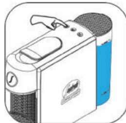
Füllen Sie den Tank auf, drücken Sie eine beliebige Taste, um die Warnung zu löschen.
