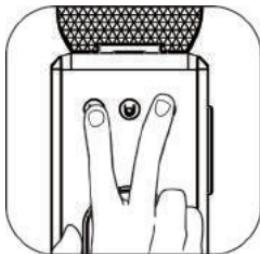
省电模式下同时按大杯和小杯按键 3 秒，蜂鸣器“嘀”一声后，咖啡机进入温度设置模式，在默认温度的基础上可上下浮动8°C。
