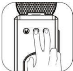
En el modo de espera, mantenga pulsados los botones Lungo y Medium durante 3 segundos; la máquina entrará en el ajuste de cantidad después de que suene el zumbido y los tres botones parpadean simultáneamente.
